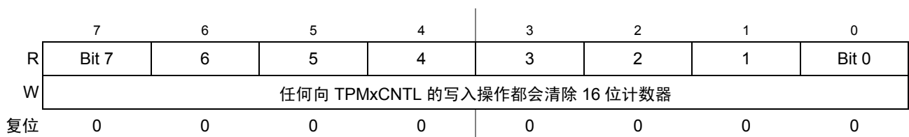
Figure 17-9. TPM 计数器寄存器低字节（TPMxCNTL）
