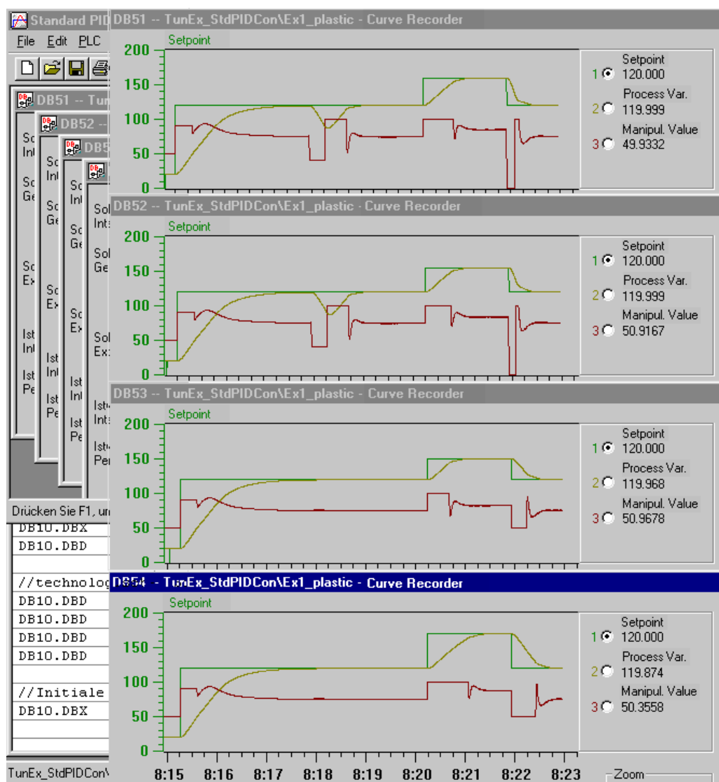
图：使用 Standard PID Control V5 的控制器优化
