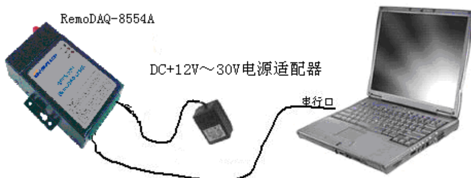
图2-1: RemoDAQ-8554A DTU配置连接示意图
