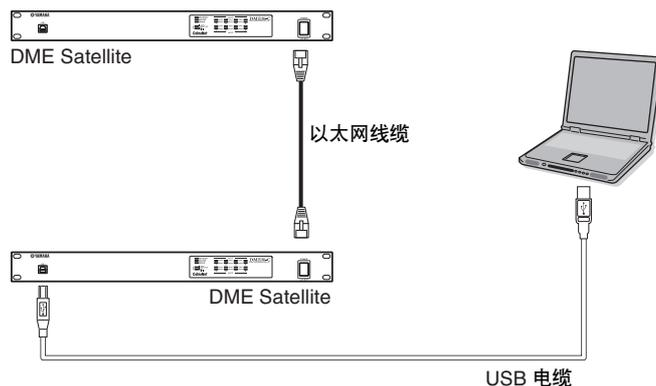
您可以在相同设备组中用以太网线直接互相连接各设备，不用通过交换机连接。如果有 DME 周边设备，你可以使用双绞线或直连线连接。在这种情况下，从 DME Designer 中，在两个设备上都设定链接模式为相同设置。在不同子网（不同网络地址）组中的设备可以通过路由器或三层交换机连接。
