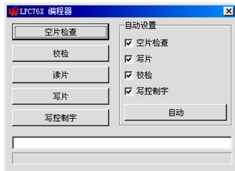
若要对芯片批量重复编程，只要在芯片编程完成后，看到电源灯慢速闪动，表示可以再次编程。换上空芯片后，按下编程器上的“YES”按钮就可以再次对芯片进行编程。
