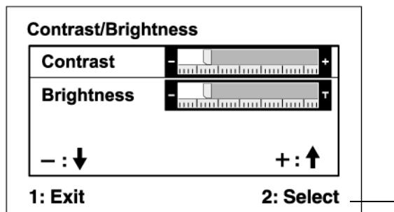
控制屏幕底部的命令行显示在此屏幕之后下一步要做什么。可在控制屏幕之间切换、调节选择的选项或者退出屏幕。
