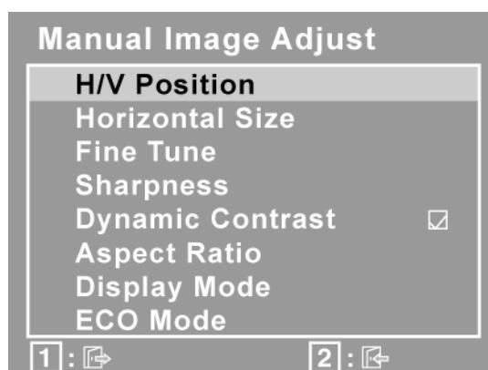
**H./V. Position**（水平 / 垂直位置）将屏幕图像左右移动或上下移动。
