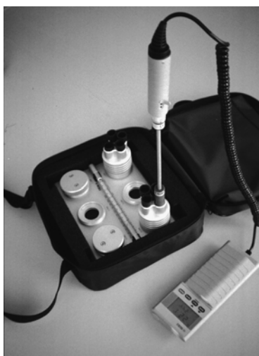
図 5.2.2 HMK15 校正器の基準塩溶液ボトルへ HMP42の挿入
