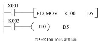
将间接指定数据寄存器的内容预先写入程序或通过数值开关输入。在指定为停电保持用寄存器时，请注意电池电压不足会造成设定值不稳定的情况
