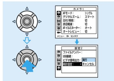
本機の設定を変えるときは、液晶画面にメニューやセットアップ画面(別冊**応用編** → 5ページ)を表示させ、コントロールボタンを使って操作します。メニューの項目を設定するときは、コントロールボタンの▲/▼/◀/▶を押して、項目や設定を選び、決定します。セットアップの項目を設定するときは、コントロールボタンの▲/▼/◀/▶を押して、項目や設定を選び、最後に中央の●を押して決定します。
