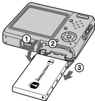
バッテリー／“メモリースティックデュオ”カバーと落下防止レバーを開け、本機を下向きに傾けて取り出してください。
