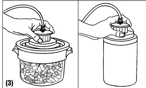
Bei der Verwendung von Gläsern mit Metaldeckeln plazieren Sie die Vakuumierkappe direkt auf den Gefäßdeckel und drücken dann senkrecht auf die Kappe (Abb.4).
