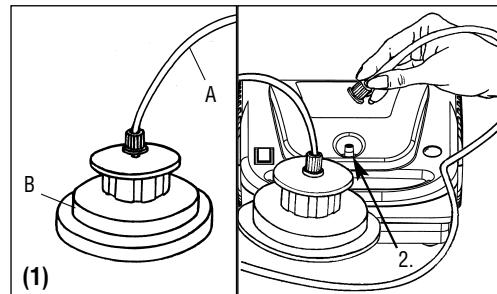
**2.** Relier avec le tube de connexion (A) l'Adaptateur pour Couvercles (B) à la prise d' air (2.) de l'appareil SOLIS COMPACT (fig.1).
