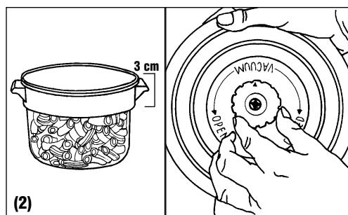
3. Füllen Sie die SOLIS COMPACT Behälter und lassen Sie mindestens 3 cm Raum unter dem Deckel und setzen Sie den Deckel auf den Behälter auf. Bei SOLIS COMPACT Behältern mit Deckel und Knopf drehen Sie diesen auf «VACUUM» (Abb.2).
