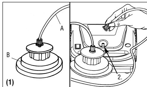
2. Verbinden Sie mittels des Vakumschlauchs (A) die Vakuumierkappe (B) an den Schlauchanschluss (2) des SOLIS COMPACT (Abb.1).
