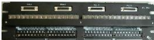
XS-32DI(FM-32DI) 32路多功能继电器隔离数字输入模块(端子板), 主要是配合DC(或PLC)数字信号输入模块使用。 输入线圈侧可进行有源、无源开关输入选择。可用来对来自危险场合的开关信号进行隔离输入。
