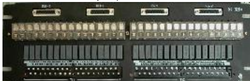
XS-32DO(FM-16DO) 32(16)路多功能通用继电器隔离数字输出模块(端子板), 配合DCS(或PLC)数字信号输出模块使用。 输入型式: 线圈侧共阴\共阳选择; 输出型式: 有源输出、无源常开接点、无源常闭接点。可用来控制电动机、电磁阀等装置。
