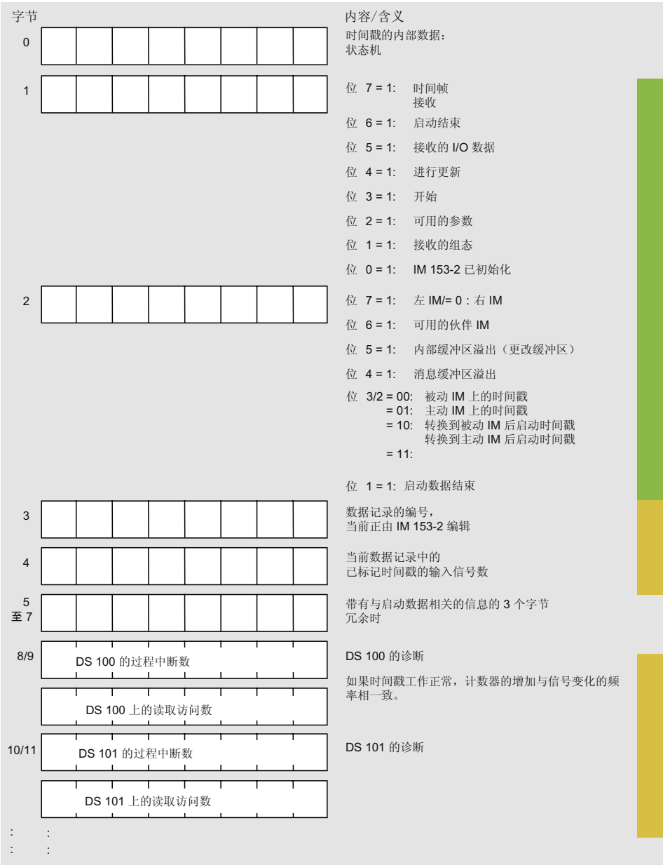
图 8-16 用于诊断的数据记录 240 的结构（第 1 部分）
