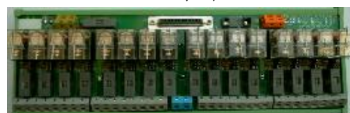
XS-32DO(FM-16DO) 32(16)路多功能通用继电器隔离数字输出模块(端子板), 配合DCS(或PLC)数字信号输出模块使用。 输入型式: 线圈侧共阴\共阳选择; 输出型式: 有源输出、无源常开接点、无源常闭接点。可用来控制电动机、电磁阀等装置。
