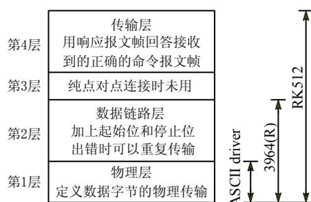
图7-33 PtP协议在ISO参考模型中的位置
