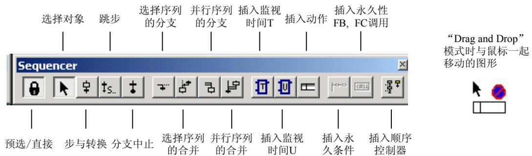
图 5-49 顺序控制器工具条与移动的图形
