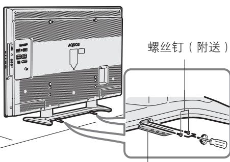
将电视机置于桌子上。用附送的4枚螺丝钉,将附送的2个固定支架安装到底座上。
