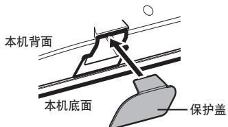
进行挂壁安装或将底座卸下后,请将保护盖按箭头所示方向插入。
