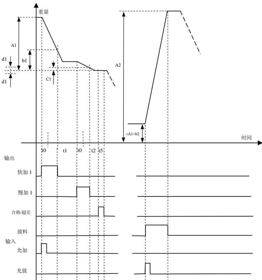
图 3-2 减法定量秤工作时序图
