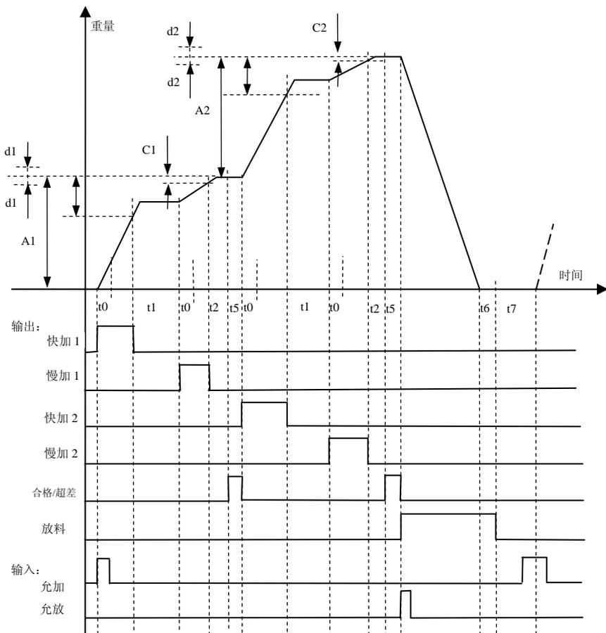
图 3-1 加法定量秤工作时序图
