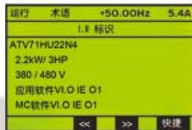
集成在变频器内的标识卡可简化已装机基础设施管理。
