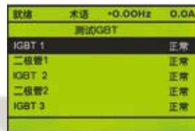
对变频器、电机、组件、输入/输出等的测试功能。
