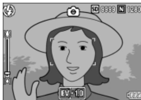
Se completa así el ajuste de compensación de exposición y en la pantalla LCD se visualizan los valores ajustados.
