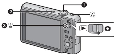
**1** Desplace el interruptor selector [REC]/[REPR.] a **[CAMERA]** luego pulse [MODE].
