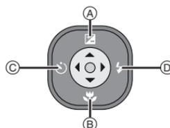
El interruptor deslizable puede ser desplazado hacia arriba, hacia abajo, a la izquierda y a la derecha para realizar una operación. En estas instrucciones de funcionamiento él se representa de la manera mostrada en la figura a continuación o se describe con ▲/▼/◀/▶.
