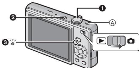
**1** Desplace el interruptor selector [REC]/[REPR.] a **[CAMERA]** luego pulse [MODE].
