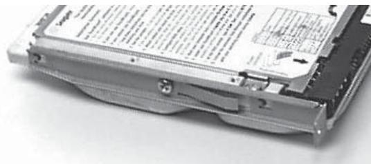
图 2-7 硬盘导轨安装图
