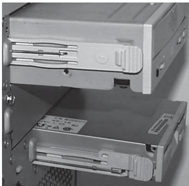
图 2-3 光驱、软驱安装图
