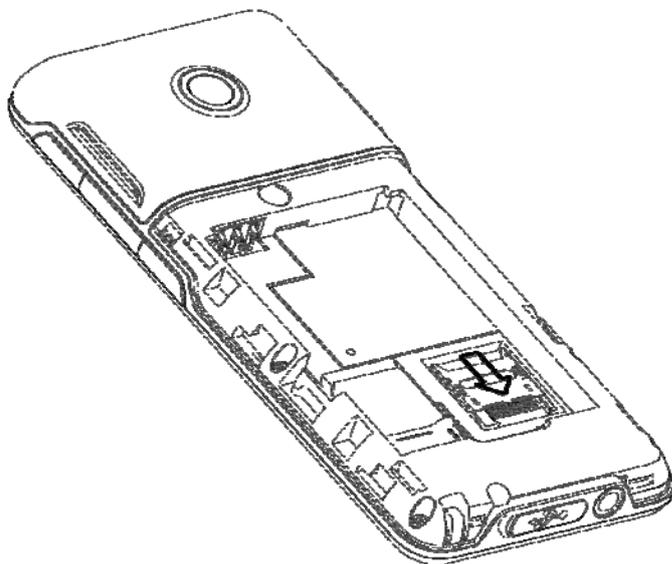
2. 保持存储卡金属面朝向存储卡卡座的弹片并放入卡座中
