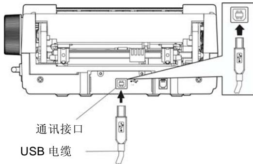
图 1-11 连接 USB 接口电缆
