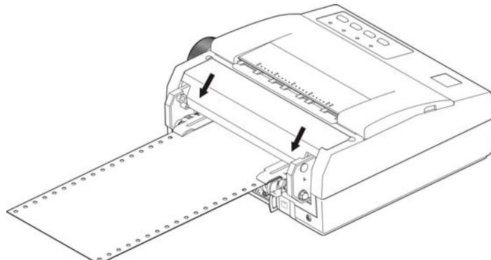
图 3-6 连续纸安装好后盖上后盖
