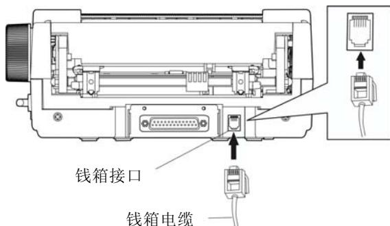
图 1-9 连接钱箱接口电缆
