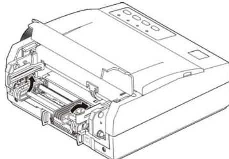
图 3-3 打开拖纸器链轮盖
