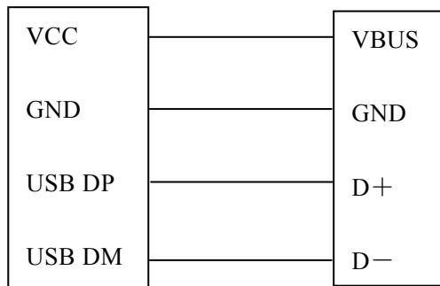
图 D-5 打印机与计算机的 USB 连接示意图
