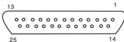
图 D-6 串行接口插座引脚序号
