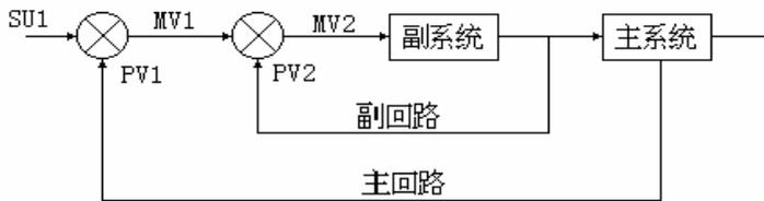
注: 在串级调节系统中, 主参数反映主产品质量或生产过程运行情况的主要工艺参数。主参数与副参数分别接受来自对象不同部位的测量信号, 其中主调节器的输出作为副调节器的给定, 而由副调节器的输出去控制调节阀, 以实现生产过程的控制。
