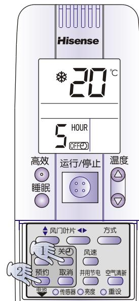
若空调器处于开机状态，经过定时器设定的时间后，空调器将停止运行。
