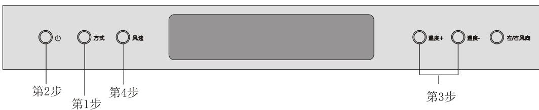
注：按键将在操作完成1分钟后自动锁定，显示屏上
