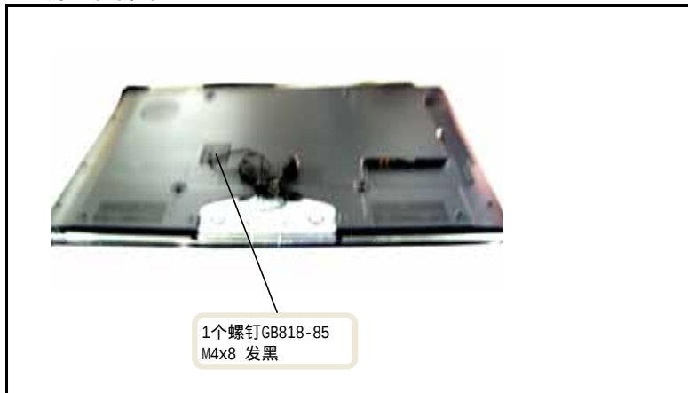
1.2电源盖板拆卸
