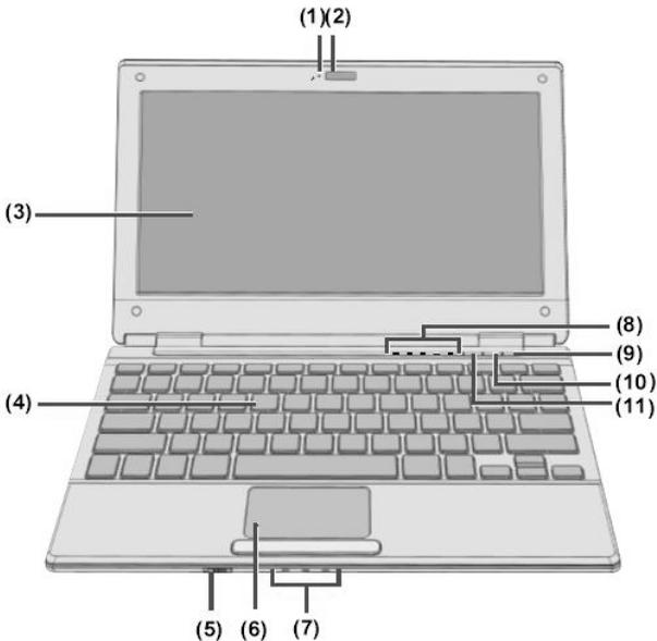
(1) **麦克风**：内置麦克风是音频输入设备，它可进行立体声接收并传输声音和其它音频数据到任何可接收此数据的程序。
