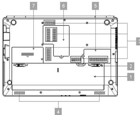
(1) **电池组**：未连接 AC 电源时，电池组对计算机供电。当连接 AC 电源时，电池组自动充电。
