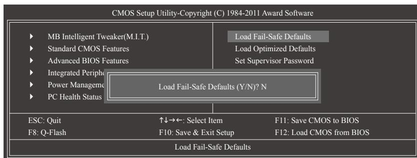
在此选项按<Enter>然后再按<Y>键，即可载入BIOS最安全预设值。如果系统出现不稳定的情况，可尝试载入最安全预设值。此设定值为最安全、最稳定的BIOS设定值。
