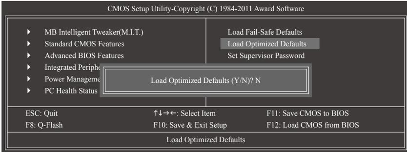
在此选项按<Enter>然后再按<Y>键，即可载入BIOS出厂预设值。执行此功能可载入BIOS的最佳化预设值。此设定值较能发挥主板的运行性能。在更新BIOS或清除CMOS数据后，请务必执行此功能。
