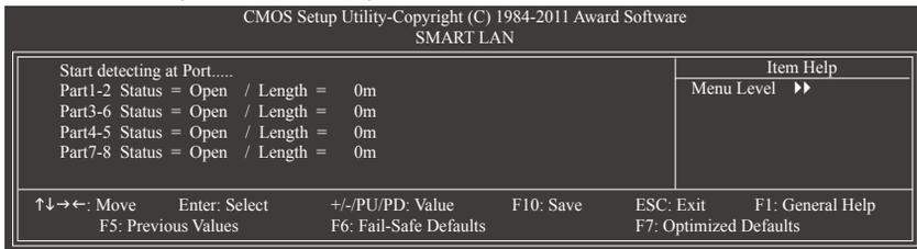
本主板具备网络线检测功能，帮助用户可以在BIOS中确认目前网络连接情况是否正常，若线路故障时亦可报告故障位置。
