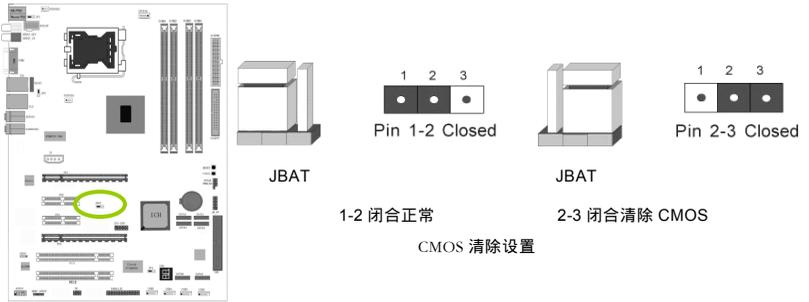
**提示:** 清除 CMOS 对于主板用户来说是一个很基本但也是一个很重要的技巧, 根据主板工程师的经验: 1. 它可以清除开机密码 2. 在超频失败后计算机无法启动时 3. 您的主板不能点亮的时候; 或是您的计算机不能进入系统, 出现错误代码提示; 或者是您的计算机出现“奇怪”的软硬件故障时, 你都可以尝试清除 CMOS, 有时是可以解决问题的, 这只是主板工程师的一些经验. 但是清除 CMOS 后计算机上的显示时间会变为出厂时的设置, 所以用户要重新设置时间, 清除 CMOS 后最好在 BIOS 里优化一下 BIOS ( Load Optimized BIOS )
