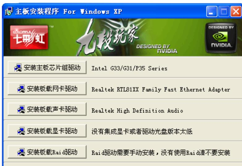
驱动光盘能自动检测主板所使用的芯片组型号、声卡型号、板载显卡型号或者板载网卡型号，点击相应的按钮安装相应的驱动。
