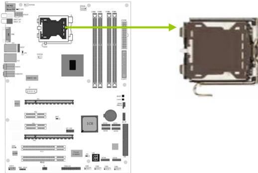
**注意：** 在安装处理器之前，请先将主板上的处理器插槽面向您，并且确认插槽的固定扳手位在您的左手边。
