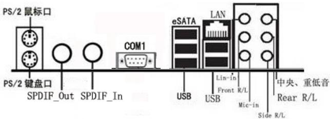
背板输出及输入接口包括：PS/2 鼠标端口，PS/2 键盘端口，USB 接口，千兆 LAN 接口，VGA 口，eSATA 接口，同轴输入，光纤输出接口，Line-in 插口，Front R/L 插口，Mic-in 插口，中央/重低音插口，Rear R/L 插口，Side R/L 插口
