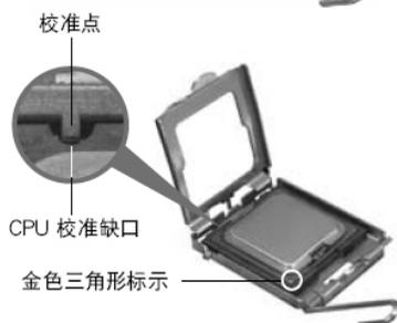
**注意：** CPU 只能以单一方向正确地安装到主板上的插槽。切记请勿用力地将 CPU 以错误的方向安装到插槽上，这么做将可能导致 CPU 与插槽上的接脚损坏。
