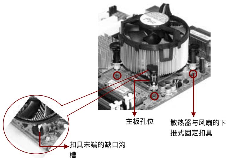
**注意：** 请确认每一个扣具末端的缺口沟槽有确实摆放在正确的位置。
