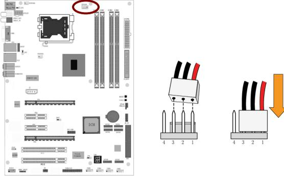
**注意：** 若您未连接 CPUFAN 的电源插槽，可能将会导致开机时 CPU 温度过热并出现自动关机的现象。
