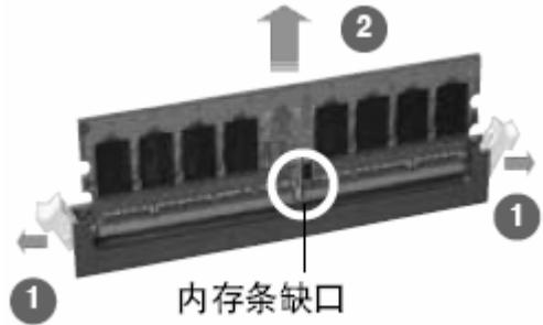
**注意：** 在压下固定卡扣取出内存条的同时，您可以用手指头轻轻地扶住内存条，以免跳出而损及内存条。
