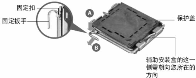
**注意：** CPU 安装盒上的保护盖是用以保护插槽上的接脚之用，因此只有在 CPU 安装妥当之后，才可将其去除。
