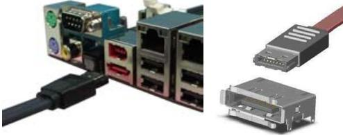
**注意：** 1. 外接式 SATA 连接埠支援外接式 Serial ATA 3Gb/S 硬体装置。较长的排线支援较高的电压需求，可以将讯号传送至二公尺远，并且支援热抽换功能。2. SATA 外接盒请另行购买。
