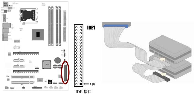
**注意:** 1.一个连接器可以连接两个硬盘。第一个硬盘应当设置成“Master”模式，第二个硬盘应当设置成“Slave”模式。2.从性能上考虑，我们建议您不要将 CD-ROM 或 DVD-ROM 驱动器与硬盘安装在同一个通道下，否则，该通道的性能将有所下降。
