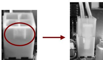
**注意:** 1.请务必连接 8 引脚 12V 电源插头, 否则可能无法顺利启动电脑。2.如果您的系统会搭载相当多的外围设备, 请使用较高功率的电源以提供足够的设备用电需求。不适用或功率不足的电源, 有可能会导导致系统不稳定或难以开机。3.如果您想要安装功率消耗较大的硬件设备, 请务必使用较高功率的电源以提供足够的设备用电需求。
