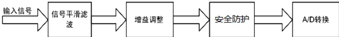
模拟量输入采样前端调理电路图
