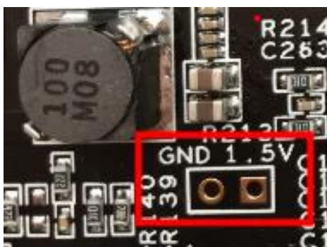
图 2.2 实物图中的电源测试点
