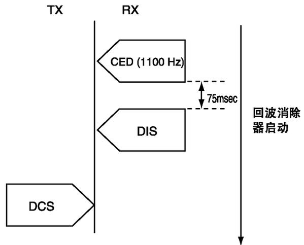
图 b (通过改变 CED 频率的对策)
