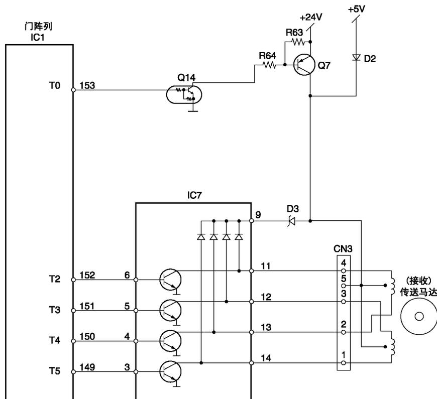
当马达关掉时，门阵列 IC1 管脚 153 变成低电平而且 Q14 和 Q7 也被关掉。通过 D2 提供的电压是 +5V，而不是 +24V，这样，马达就固定在适当的位置。
