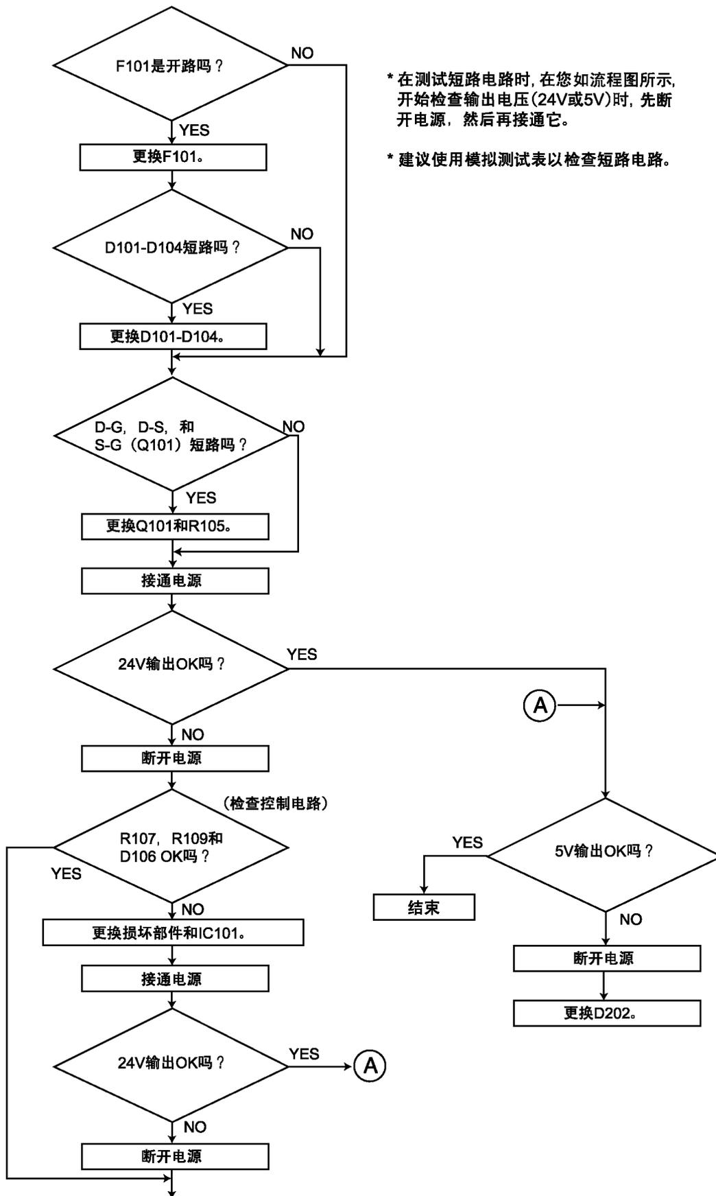
\* 在测试短路电路时, 在您如流程图所示, 开始检查输出电压(24V或5V)时, 先断开电源, 然后再接通它。
