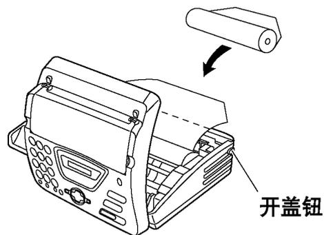
(2) 将热敏记录纸的引导边缘向机外拉出约 10 厘米。确保热敏记录纸卷上没有松弛现象。
