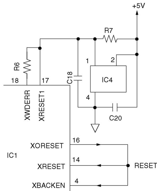
装在门阵列 (IC1) 里的监控计时器约每 1.5 毫秒初始化一次。当监控器发生故障时, 门阵列 (IC1) 的管脚 18 上的电压变低。
