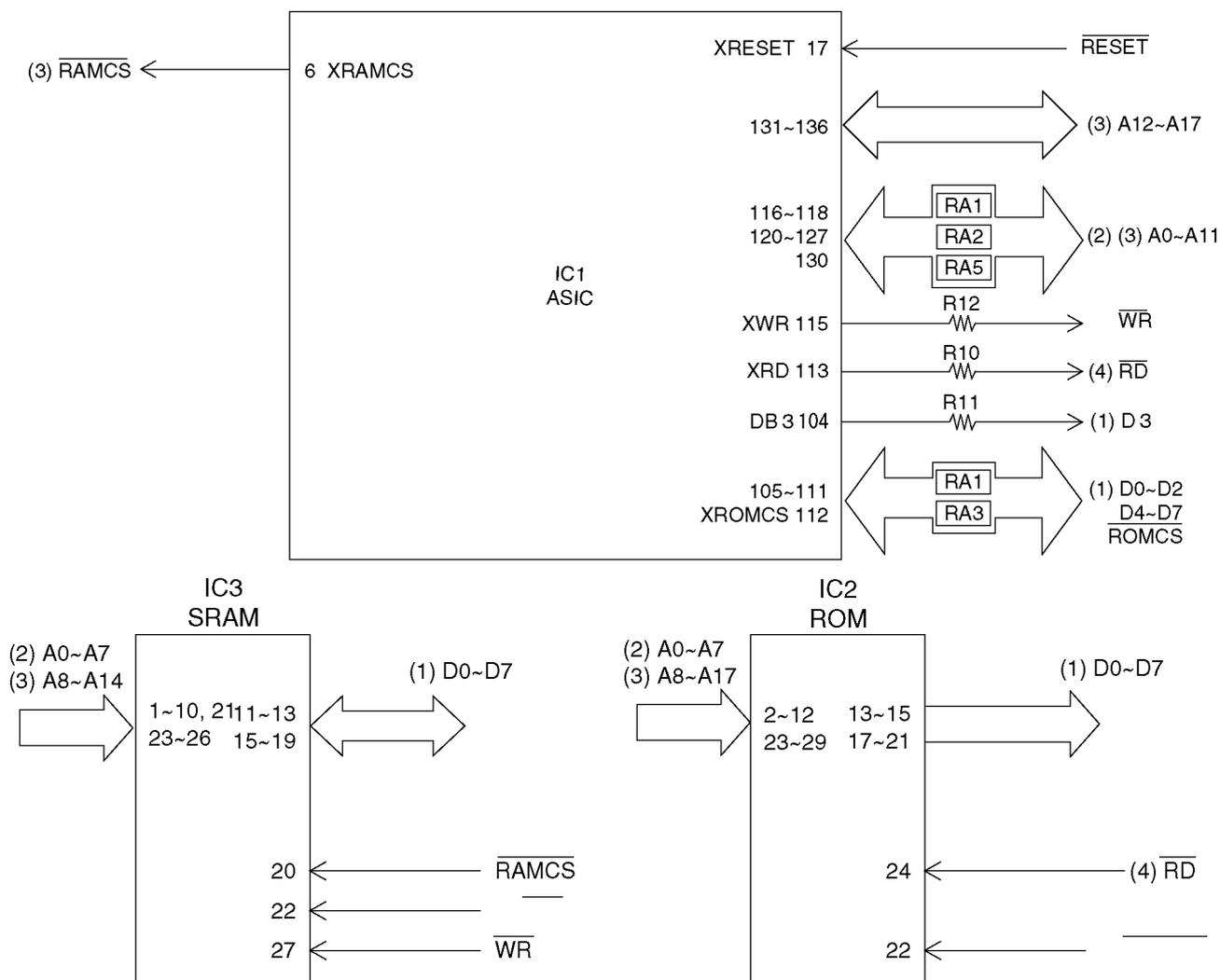
电源接通后，ASIC（CPU）启动并检查每个 IC。
