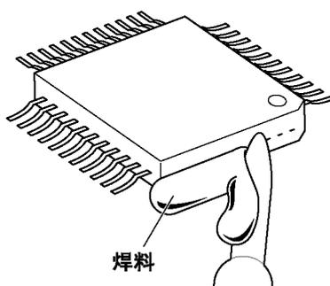
当您往板上安新的 IC 时，可用例如焊线之类的工具除去所有遗留在焊接区上的焊料，如果在板上的接点处留有焊料，就不能正确地安放新的 IC。
