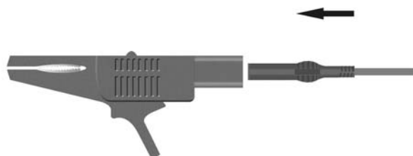
图 4-3 测试线与鳄鱼夹连接示意图
