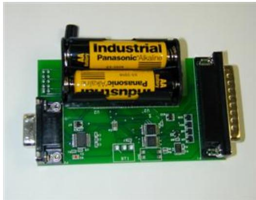
连接到编程主板上的 Mica 微粒
