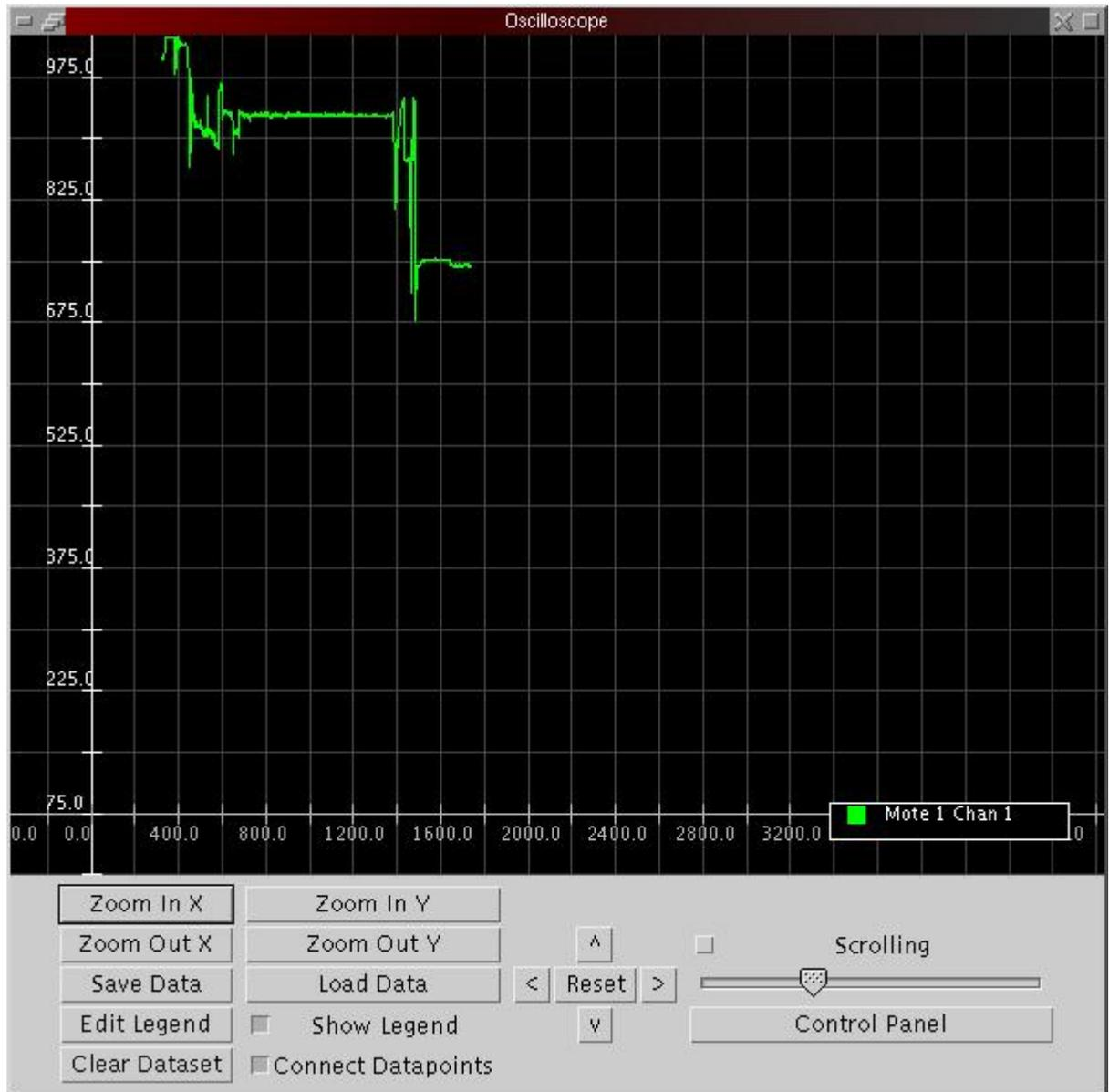
该图形的 X 轴表示数据包的数量值，Y 轴表示传感器的光强数值。如果微粒运行过久，数据包数值会较大，所以图中可能会显示不出传感器数据；这时只需将微粒的电源断开再打开，这样可将数据包计数器重置为 0。如果在显示区看不到传感器光强数据，需将其缩放到适当大小。
