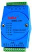
MODEL2115B (485 分配器) 捷瑞公司针对工业应用而设计生产的一款高性能 RS232/RS485↔4PORTS RS485 产品, 用来完成对 485 总线的分配, 以扩展 485 线路的通信能力, 延长通信距离, 使用它更便于组建 485 网络。本产品采用捷瑞工业模块式设计, 支持导轨式安装、壁挂式安装等安装方式。另外产品采用光电隔离传输信号可以有效的保护您的设备和网络, 9~24V 可变电压供电使用更方便。
