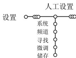
电视频道的搜寻和储存是按每个频道逐一进行的。您必须执行人工设置菜单中的**每个步骤**。
