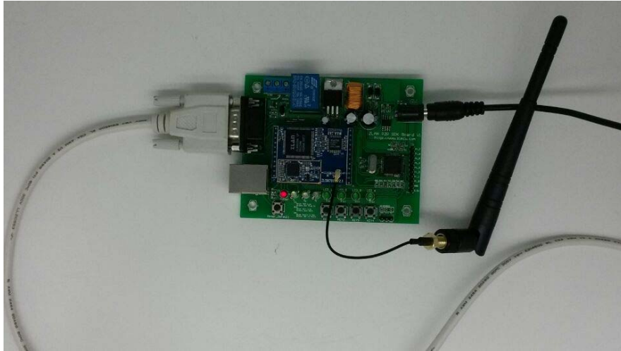
图 5 硬件连接图(Wifi 模块连入无线网)
