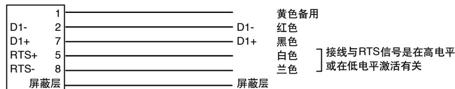
注释：编程电缆通过它的灰色区分 ASCII / MODBUS® 通讯电缆
