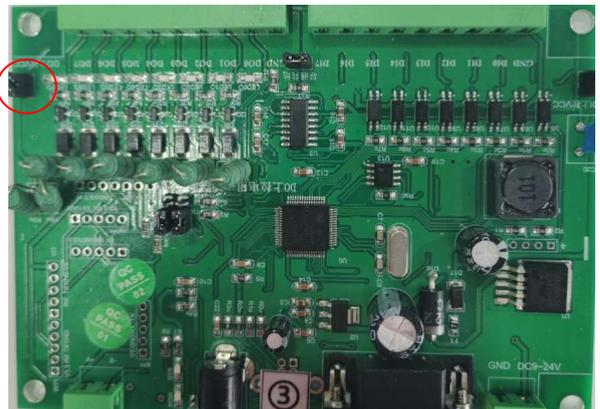
用法二：给外部设备提供 PWM 信号，如下图所示，设备正极接外部 DO，设备负极接 GND，可以输出 0/VCC，电流 5mA。注意：采集卡内部左上角跳线帽需保留。
