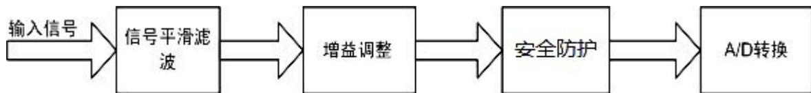
模拟量输入采样前端调理电路图
