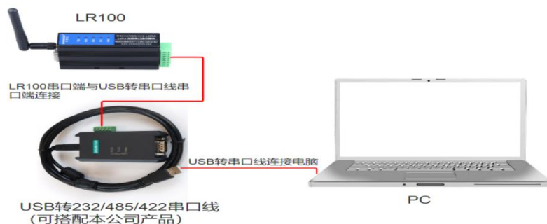
图 4.2 LR100 参数设置接线示意图
