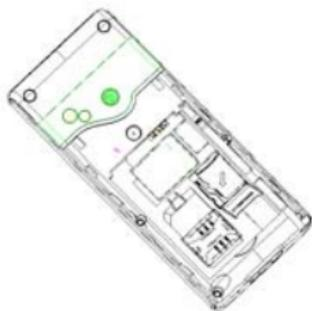
3. 将卡和插槽板向下与手机插槽吻合并将插槽板向图中箭头方向推直到卡住。
