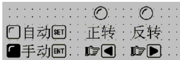
此时设备处于手动状态，按“SET”键将设备置为自动状态，即 PLC 的 M10 被置 ON。
