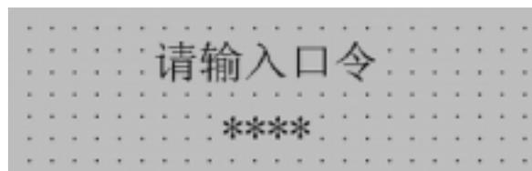
按数字键盘输入密码值，屏幕显示\*号表示输入的数字。输入完成按“ENT”键确认。如果口令正确，画面显示：
