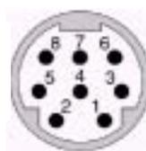
**注意：**由于三菱 FX 系列 PLC 通讯端口的升级，客户须采用我公司提供的 MD2-FX2N 电缆或三菱公司的编程电缆 SC09 才能保证 MD204L 和 FX 上述系列 PLC 通讯正常！
