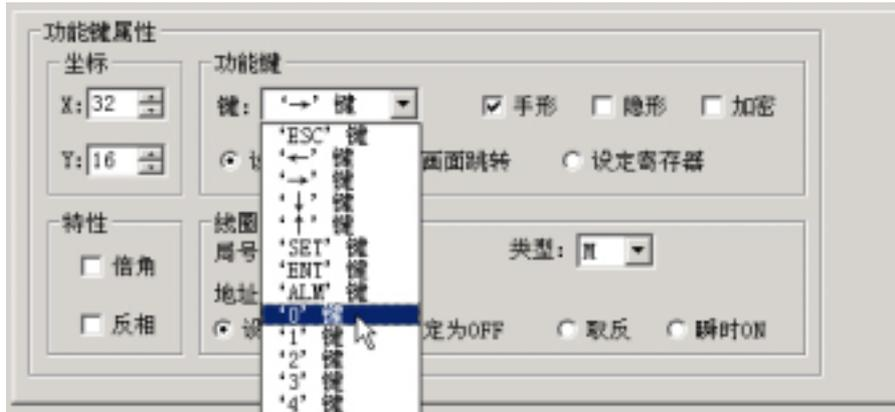
如果为了简明起见，可以取消手形显示，屏幕只显示按键外形。随后将功能设定为画面跳转，此时在其下方设定跳转画面号，将目标画面号设定为 10，即第 10 号画面为参数设定画面。
