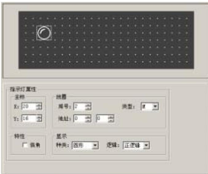
线圈定义号表示指示灯对应 PLC 开关量地址
