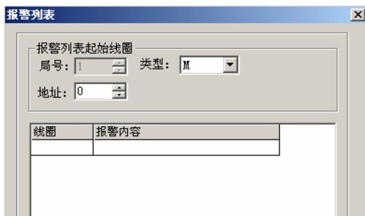
因为没有输入任何内容，报警列表内容是空白的。首先，将光标移至《报警内容》栏，写入报警信息[工作温度过高]，回车确认后屏幕显示：
