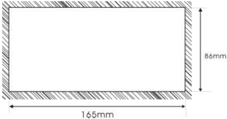
MD204L 出厂随机配备 4 个铁制安装螺钉，显示器的背部外壳的上下侧面各有两个方形固定孔，使用安装螺钉将显示器紧密固定在控制柜安装孔上。装配步骤如下：
