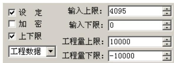
这样，当寄存器中输入 A/D 转换值时，就可以显示电压值了。
