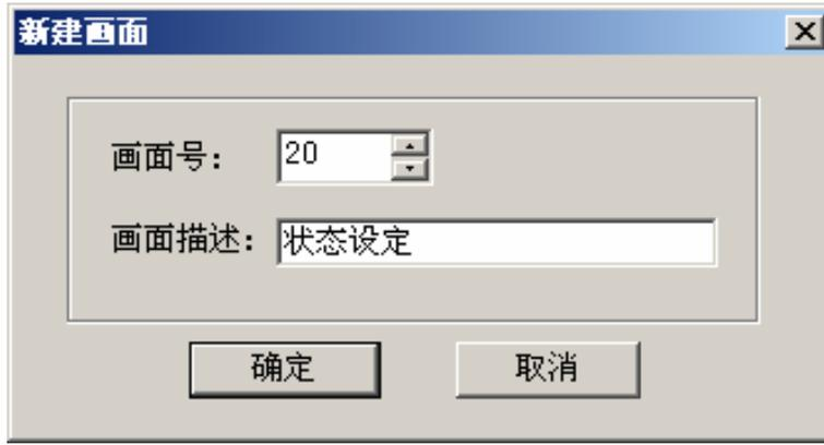
按[确定]键确认。随后界面右下角显示画面属性内容，将“ ”键跳转画面号置为“0”，“ ”键跳转画面号置为“10”。以便在运行状态下，按“ ”键直接进入菜单画面，按“ ”键直接进入参数设定画面。
