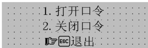
用上下键和 ENT 键选择 1，执行打开口令操作；选择 2，使系统处于口令关闭状态；按“ESC”键，退回监视状态。
