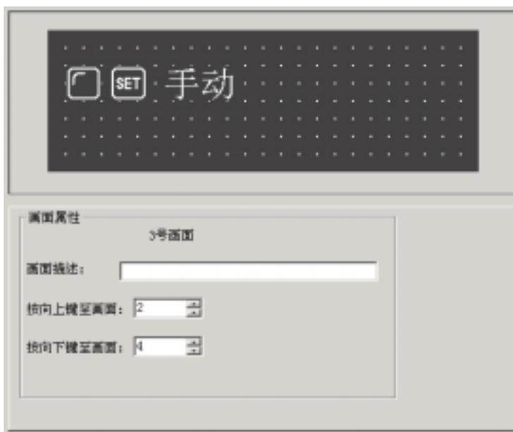
以同样方法设置 *手动* 按键，*手动* 状态指示灯。指示灯的地址仍然对应 M10，显示属性取负逻辑。指定按键为“ENT”键，按键功能为置 M10 继电器 OFF。
