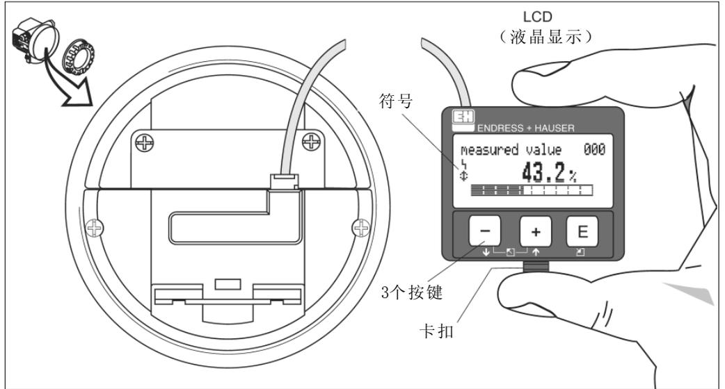
如上图所示，只需按下卡扣就可将VU331 LCD显示单元取出来。该单元通过长度为500mm的电缆与仪器相连。
