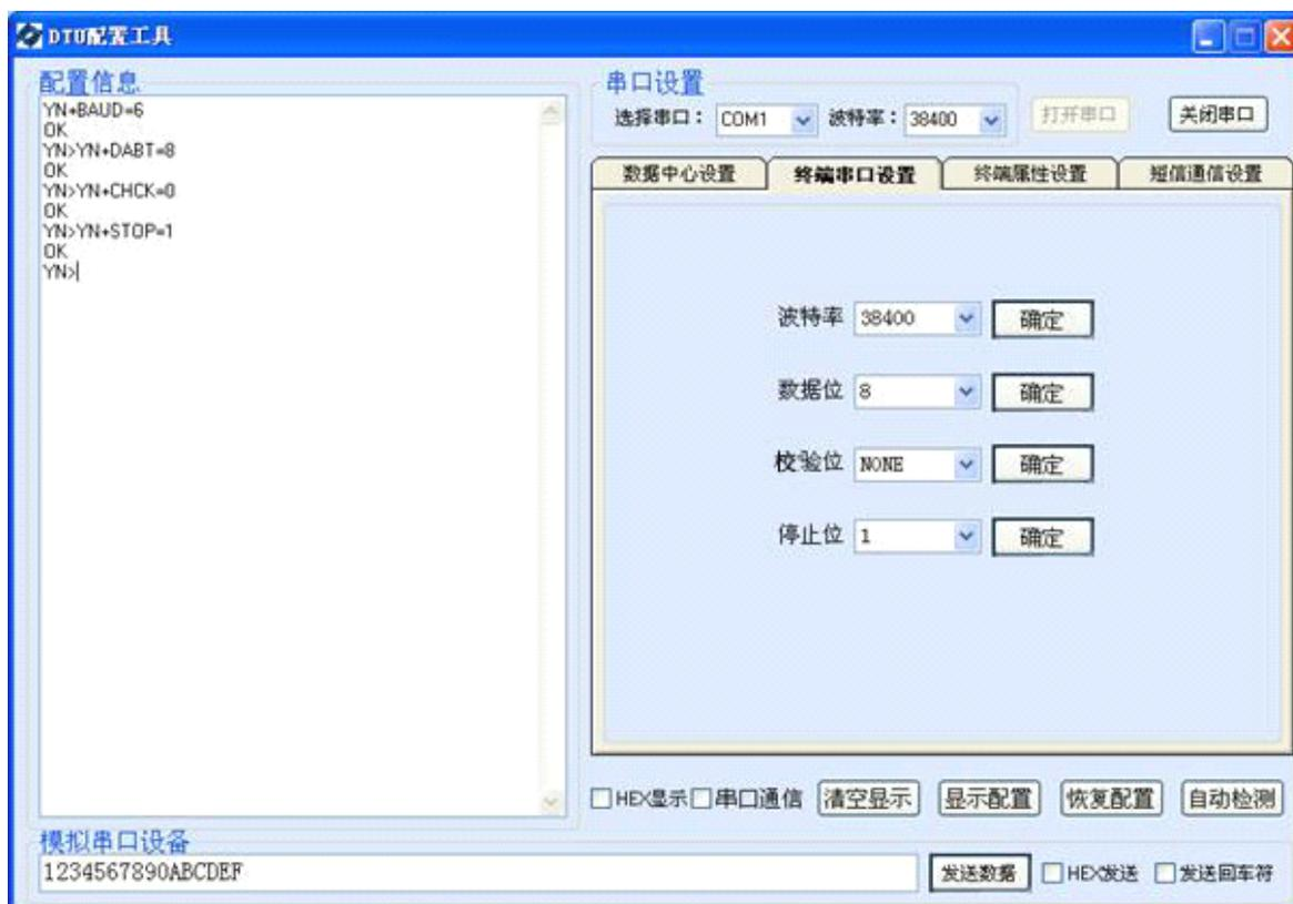
当 DTU 与下位机通讯时，DTU 的串口参数（波特率，数据位，校验位，停止位）必须与下位机通讯串口参数一致，否则将无法通讯或通讯出错，具体根据下位机而定。
