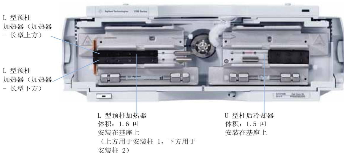
图 1 新的额外加热器和冷却设备
