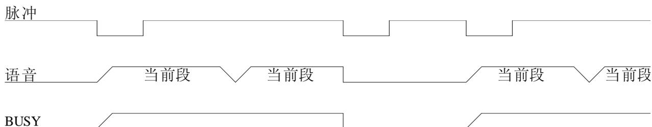
备注：负脉冲触发，当 I/O 口检测到有下降沿时（如，该 I/O 口对地短路一下），触发播放语音，语音播放完一遍后，自动继续播放当前段语音。在语音播放期间，如果再次检测到有下降沿，就停止播放语音。再次对该 I/O 口触发，则从头播放该段语音且会自动循环播放。控制方式如此循环渐进。
