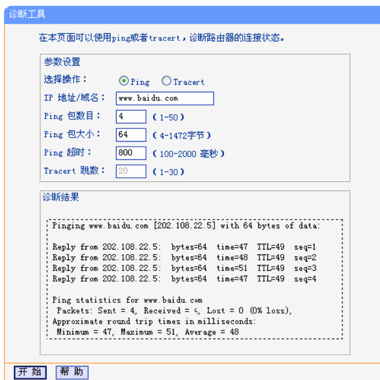
图 5-66 Ping 诊断结果—成功
