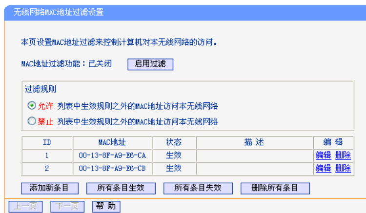
图 5-20 无线网络 MAC 地址过滤设置
