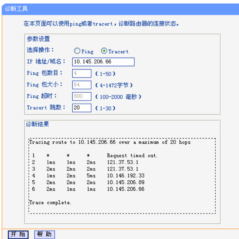
图 5-68 Tracert 诊断结果—成功
