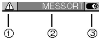
警告符号 ( 仅在有装置错误时 ; 装置错误显示在仪器诊断菜单中 )
