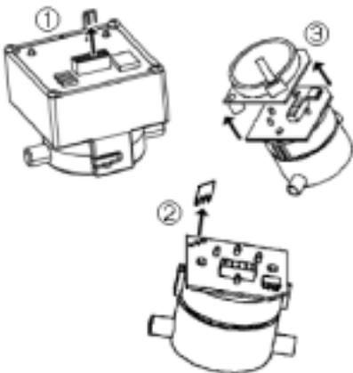
**!** 仅就在插入之前从新的传感器组件上拆下短路托架/附板。不要让传感器组件在没有短路托架/附板的情况下放置超过 15 分钟。
