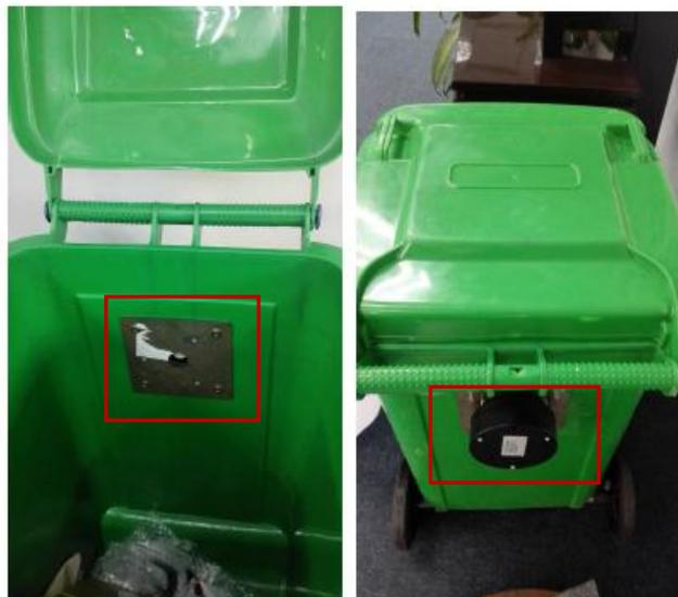
在安装过程中，需要使用工具钻孔并拧紧螺钉。并确保传感器与垃圾桶地面尽可能垂直。如果安装空间太小，请尝试从垃圾桶上卸下垃圾桶盖子，安装完毕后重新将顶盖安装到箱体。
