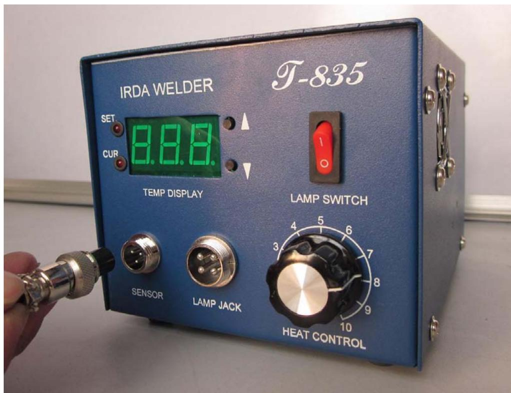
②、 将红外灯连接线插头对准插座，插入相应连接线插座。
