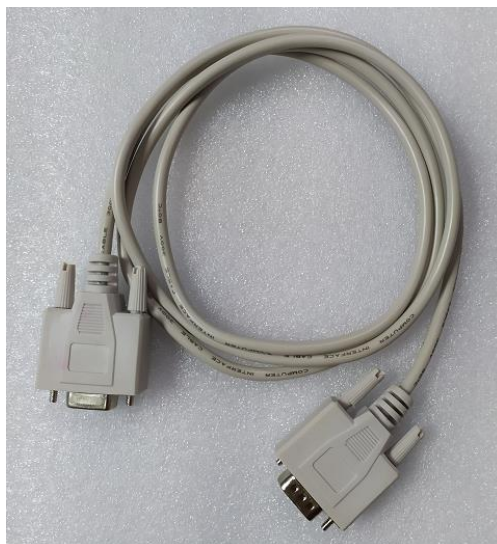
图 1-5: 九针九孔直连串口线
