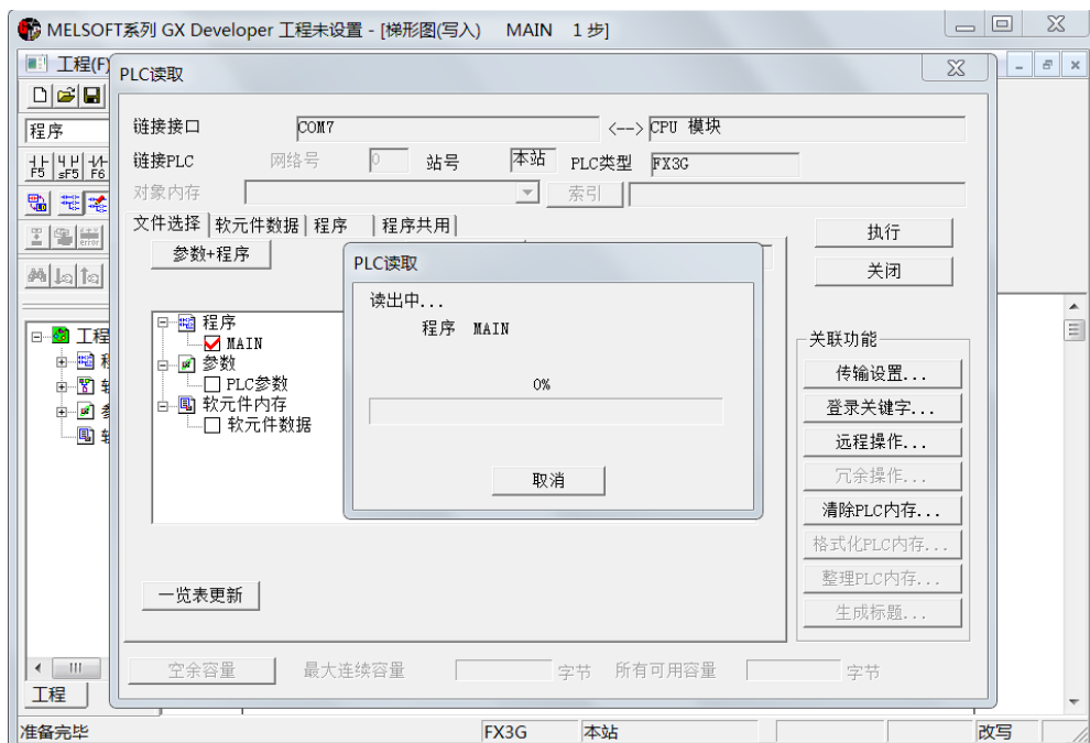
图附 8-16：读取 PLC 程序过程中
